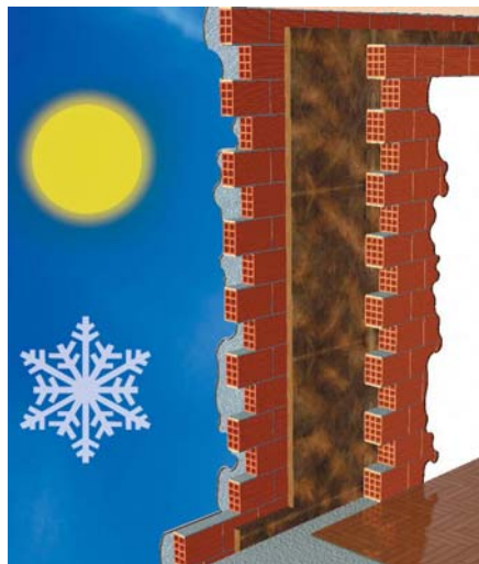
Figura 2: Solución constructiva. Instalación de PANEL SIN REVESTIR (TP 116) sobre el trasdós de una hoja de fábrica y cierre posterior mediante una segunda hoja
